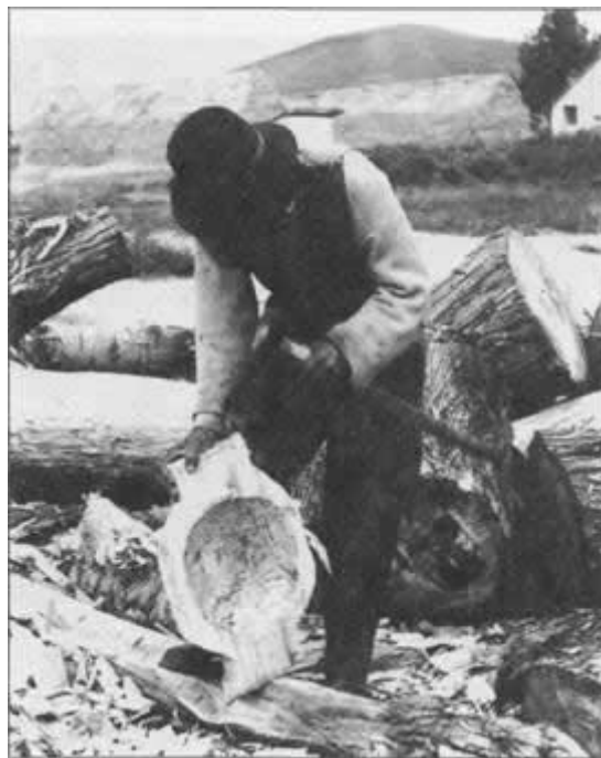
5. A szakajtó iáragása baltával. Carving a bread-bowl with an axe
